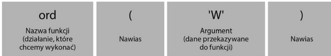
Rysunek 2.8. Anatomia wywołania funkcji
